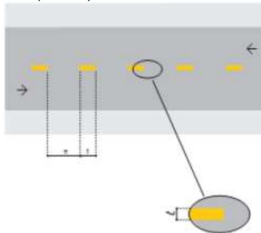
A LFO-2 divide fluxos opostos de circulação, delimitando o espaço disponível para cada sentido e indicando os trechos em que a ultrapassagem e os deslocamentos laterais são permitidos. É pintada na cor amarela e deve ter medidas de traço e espaçamento (intervalo entre traços), definidas em função da velocidade regulamentada na via, conforme quadro a seguir:
