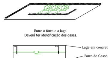
DETALHE CAIXA DE VÁLV. SEÇÃO
