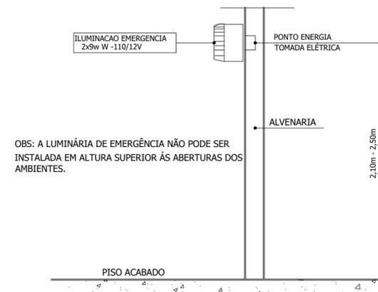
OBS: A LUMINÁRIA DE EMERGÊNCIA NÃO PODE SER INSTALADA EM ALTURA SUPERIOR ÀS ABERTURAS DOS AMBIENTES.
