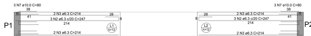
Armação positiva das lajes do pavimento assento (Eixo X)
