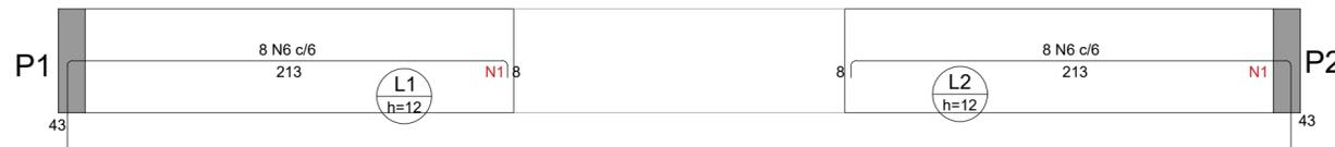
Armação negativa das lajes do pavimento assento (Eixo X)
