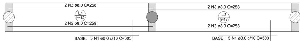
Armação inferior do radier do pavimento base (Eixo X)
