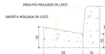
DETALHE MEIO-FIO E SARJETA SEM ESCALA
